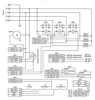
Схема электрическая принципиальная котла Tenko «Standart Digital». Напряжение питания котла- 380В, Напряжение питания ТЭН -220В.
