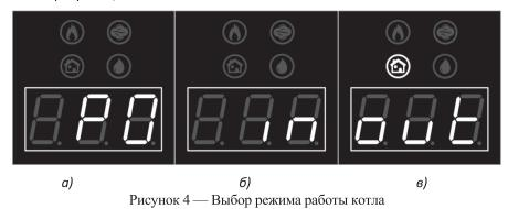
После входа в данный раздел (нажатием кнопки «Ок») на дисплее отобразится активный на данный момент режим. Режиму встроенного термостата соответствует символьное обозначение **in** (рисунок 4,6), а режиму внешнего термостата соответствует символьное обозначение **out** (рисунок 4,8). Так же при выборе последнего загорается индикатор «Комнатный термостат». Выход из раздела осуществляется нажатием кнопки «Ок».
