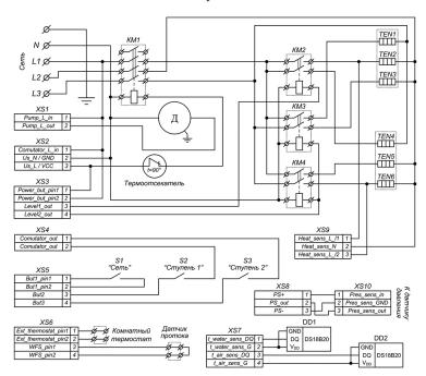
Схема электрическая принципиальная котла Tenko «Standart Digital+». Напряжение питания котла- 380B, Напряжение питания ТЭН -380B, 2 блока
