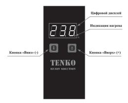
Рисунок 1. Панель управления котла DKEM
