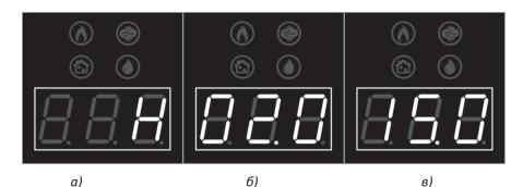
а) б) в) Рисунок 8 — Установка пауз включения и выключения насоса
