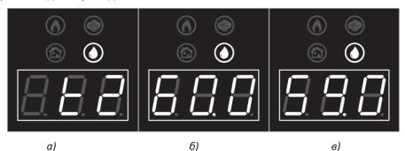
Рисунок 3 — Настройка границ температуры теплоносителя
